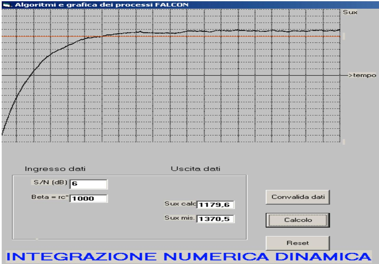
4- con -6 dB di S/N e  $\beta = 1000$  l'integratore rende, una volta a regime, l'uscita con sensibile varianza..
