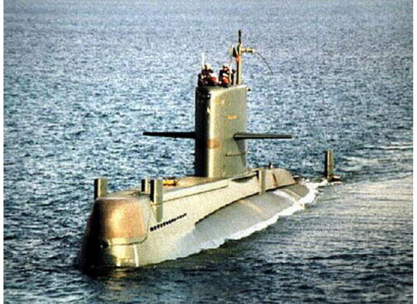
Sottomarino Sauro; in vista le 6 pinne del misuratore passivo della distanza, in alto a prua, di colore diverso dal resto dello scafo, la calotta idrodinamica che copre la base ricevente cilindrica del sonar IPD70S
